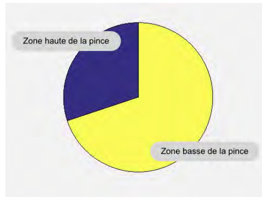
FIGURE 10 – Représentation graphique de la proportion de force haute et basse dans la pince
