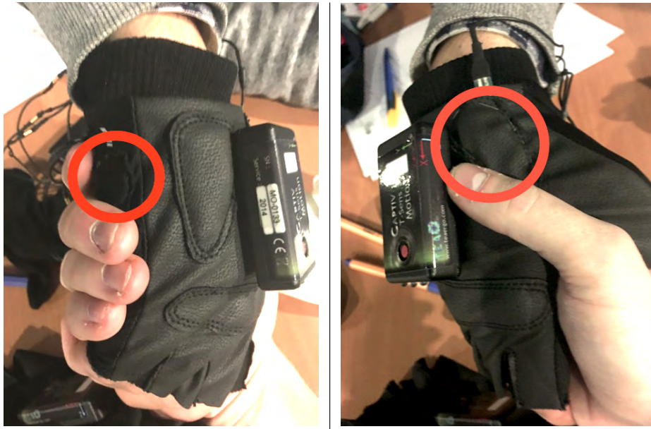
FIGURE 5 – Des capteurs non sollicités lors d’une poignée de main
