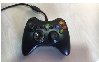
Illustration 9: Manette permettant un contrôle manuel de la lampe
